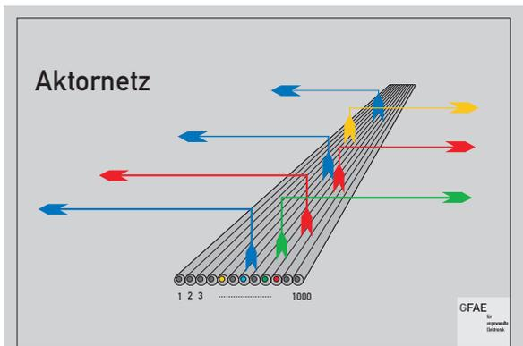
Die Netzmanagementfunktionen des Kopplernetz reduzieren die Kommunikationszeiten und vereinfachen die Verwaltung. Die Ausgänge werden mittels Konfigurationsschalter einer Adresse zugeordnet.
