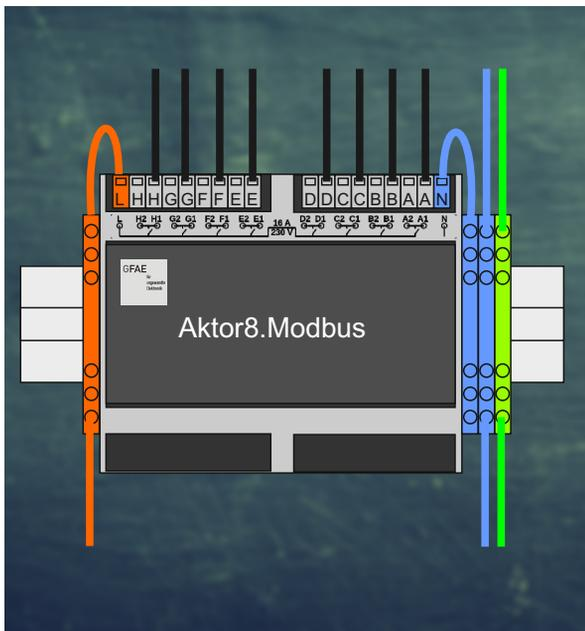
Aktor8.Modbus eignet sich für den Einsatz direkt in der Klemmenebene. Für jeden der 8 geschalteten Abgänge sind 2 Klemmstellen vorhanden. Die Busverbindung kann von Modul zu Modul durchgeschlauft werden. Die Montage unmittelbar bei der Steuerung oder in abgesetzten Kleinverteilern ist gleichermassen geeignet.
